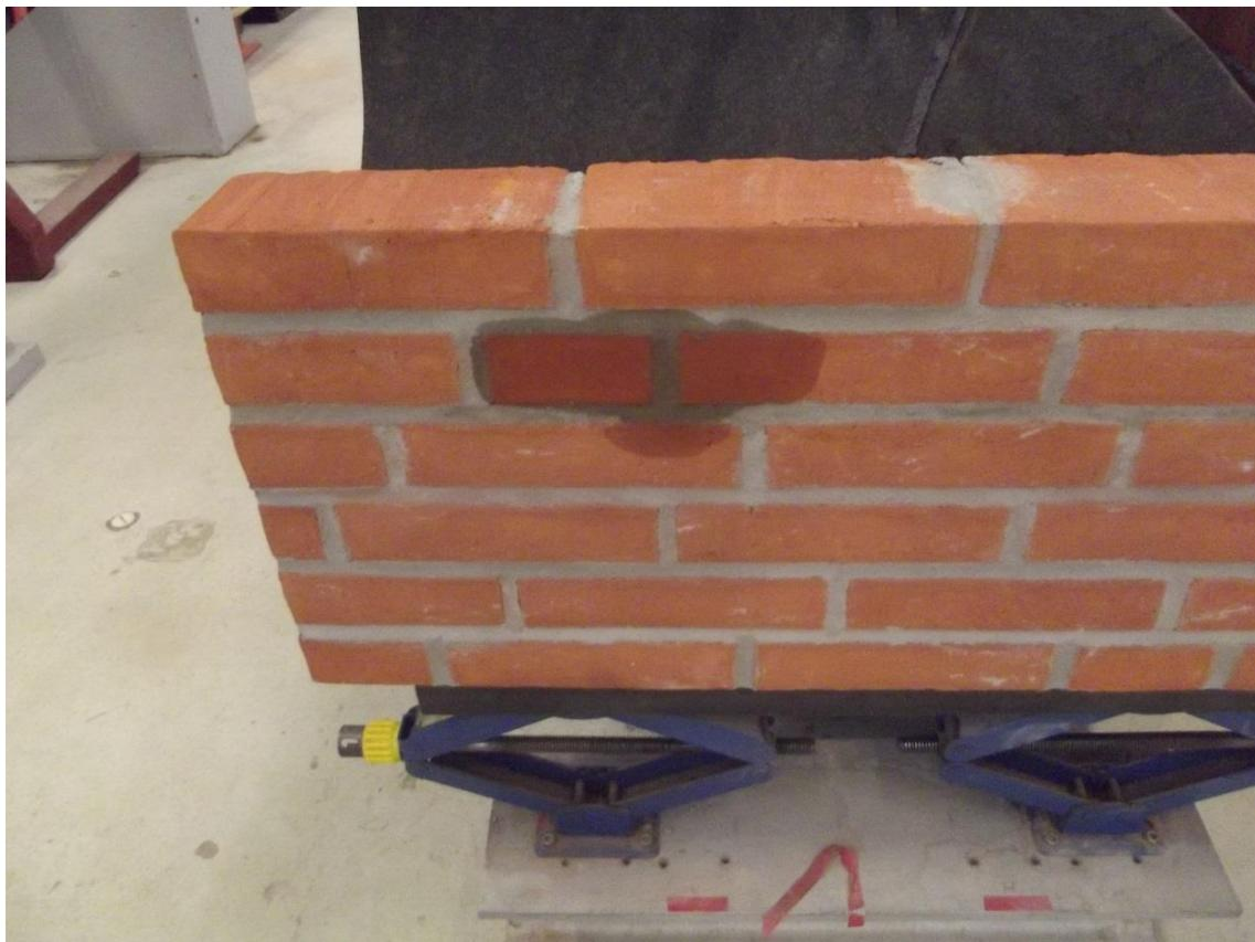
Figur 7.2. Murværk opført med "slåede studser over hele kopenden" undtagen én, hvor vand i fugt-spærren ses at løbe igennem denne ene ikke-slåede studsuge
