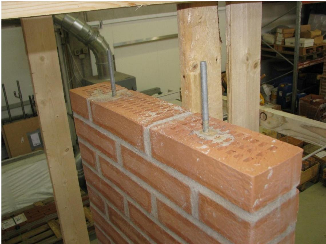
Figur 21.2. Forankring med Ø10 indlimede gevindstænger
