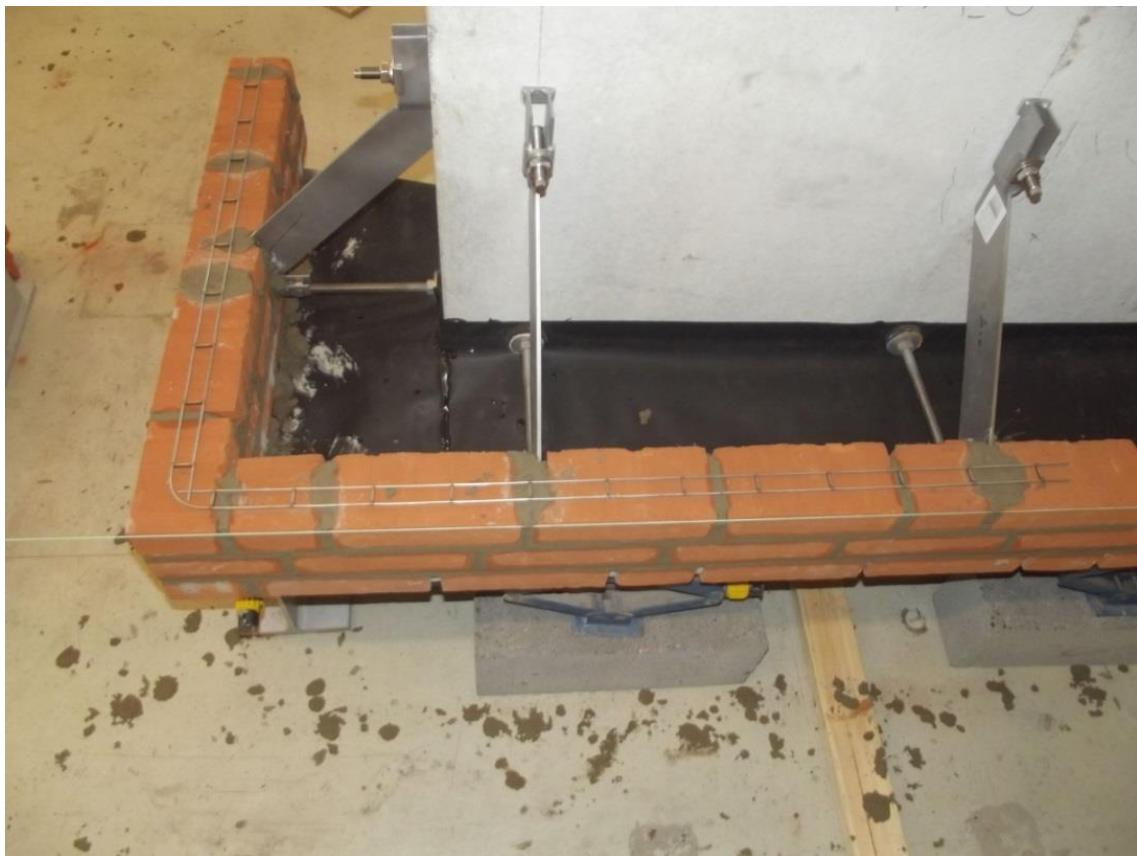
Figur 18.8. Armering i de overliggende skifter
