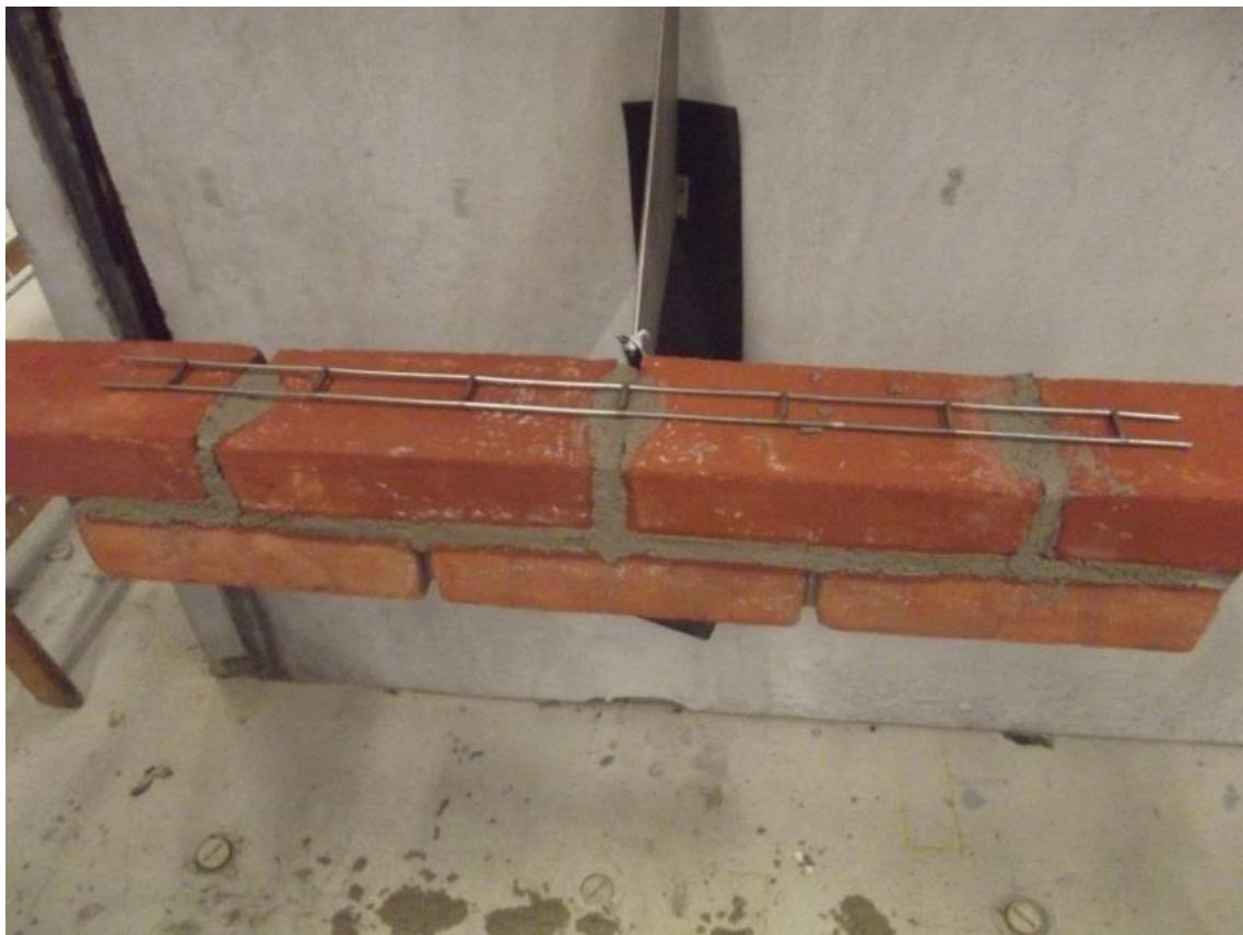
Figur 18.10. Enkel forstærkning af det svækkede tværsnit, hvor konsolkroppen "skærer" sig ind i murværket
